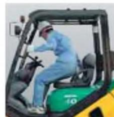
Когда оператор покидает свое сиденье, включается система определения присутствия оператора на рабочем месте (OPS)
