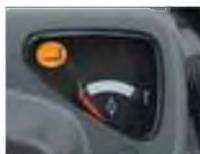
Контрольная лампа блокировки подъемника на панели приборов
