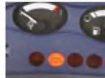
Индикатор неисправности двигателя
