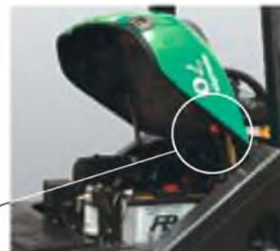
Фиксация капота двигателя обеспечивает безопасное обслуживание
