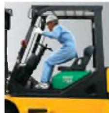
Когда оператор покидает свое сиденье включается система определения присутствия оператора
