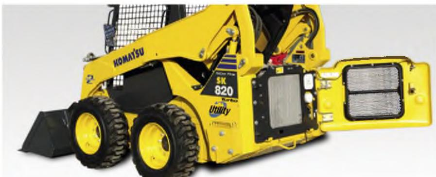
Задняя дверь: удобная проверка и очистка радиаторов
